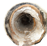
Présence de tartre (tube fonte)
