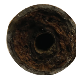
Formation de biofilm (tube fonte)
